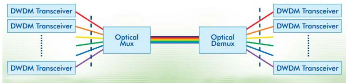
4. ábra: Optikai multiplexer és demultiplexer [5]
