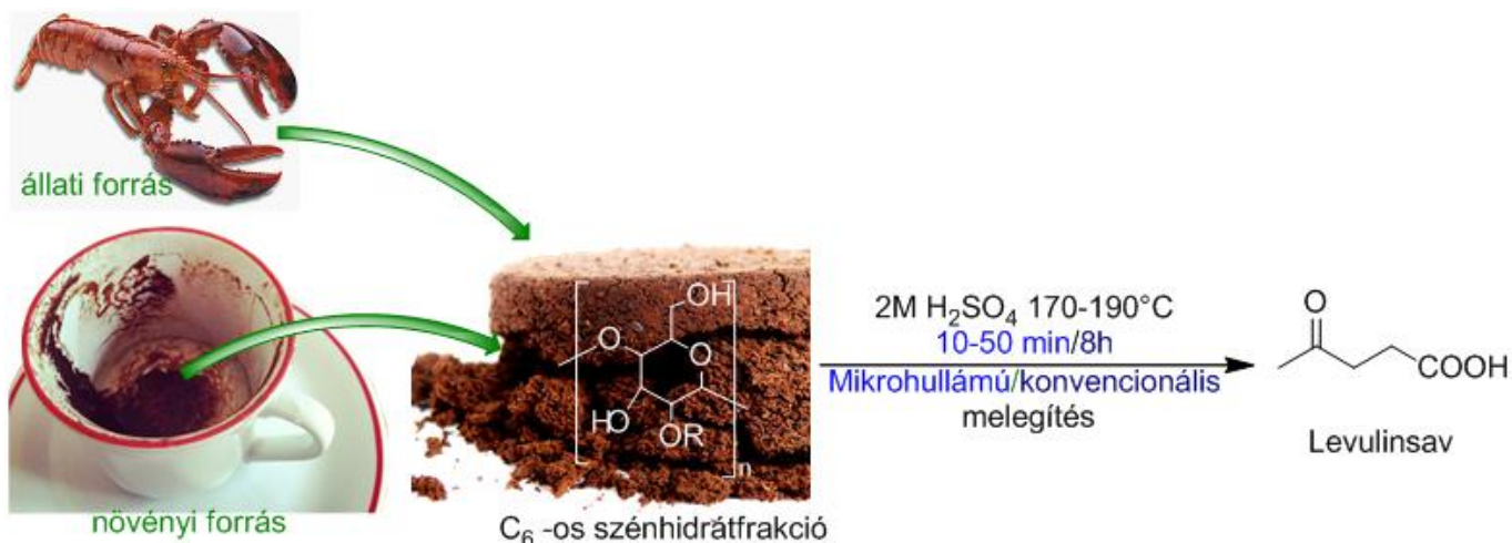
4. ábra Biomassza savkatalizált dehidratálása levulinsavvá
