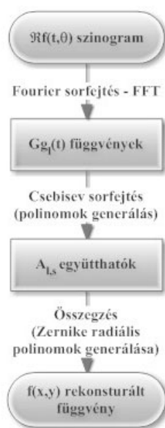
3.1. ábra. Rekonstrukciós algoritmus blokkdiagramja.
