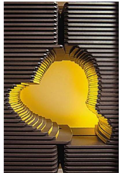
(b) Varian Millenium 120 MLC (felülnézeti kép) [8]
