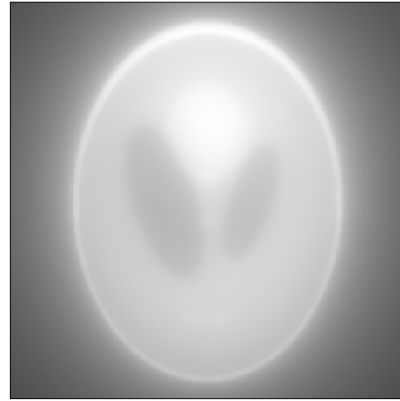
1.2. ábra: A Shepp-Logan fantom szűrt, illetve szűrés nélkül végzett visszavetítése
