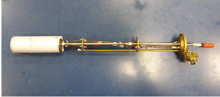
14. ábra. A használt mérőfej. Baloldali vége a mintatartó, a gradiens és RF tekercsekkel, jobb végén az RF és gradiens kábelek csatlakozása.
