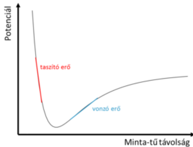
3.1. ábra. A tű és a minta közt fellépő potenciál fejlődése a tű-minta távolság függvényében [17]
