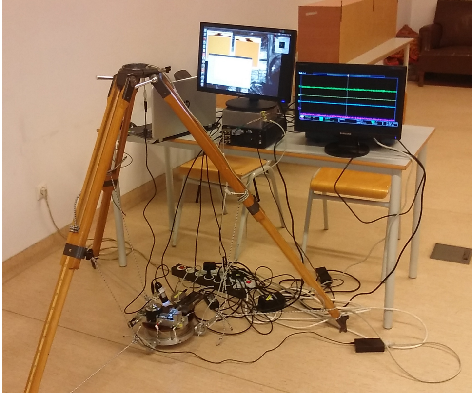
2.20. ábra. A demonstrációs célú STM összeállítása.
