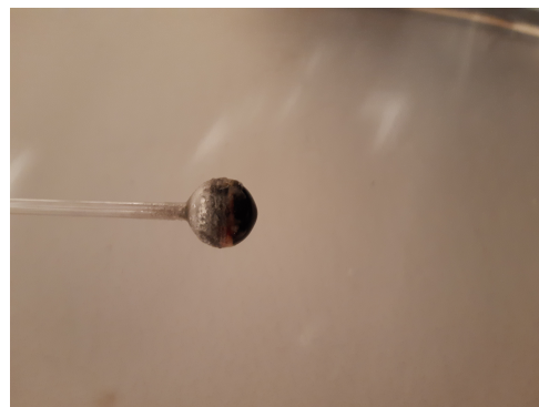
(b) A minta a szintézis végeztével az ammónia elforralása után. Jól látható a kialakult nátriumtükör, amely zavarja a méréseket, ezért indokolt az utólagos hőkezelés
