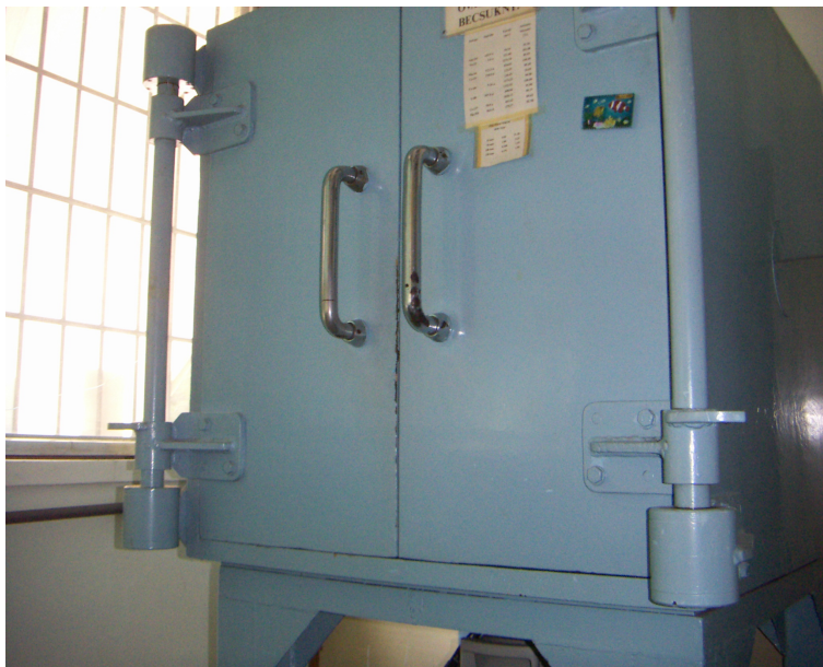
2.1. ábra. A detektor árnyékoló kamra.
