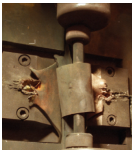
(b) mérés utáni szétrobbant tekercs.[14]
