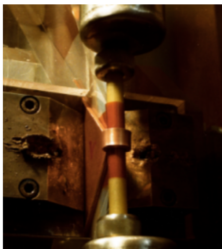
(a) Tekercs benne az összeszerelt kriosztáttal.[14]
