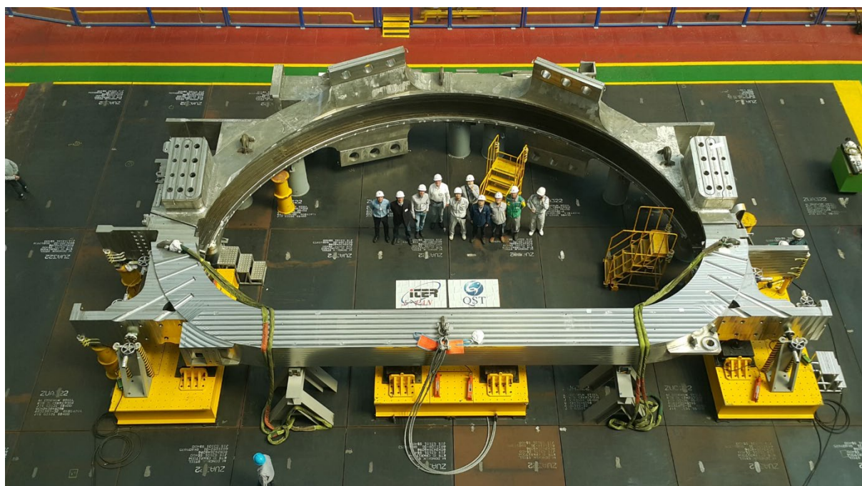
8. ábra: Az ITER egyik toroidális tekercsének acél burkolata, 2018 május [4].
