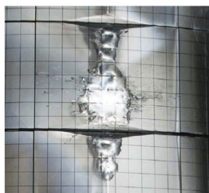
12. ábra: Elfutó elektron által megolvastott berendezés elemek a JET tokamakon [5].
