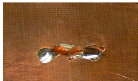
ábra 31. A szenzorfej alján az érzékelőegység kiképezése
