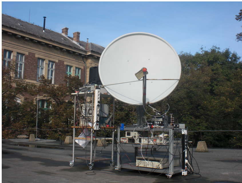
4.2. ábra. A megépített Hold-radar a BME L épületének tetején
