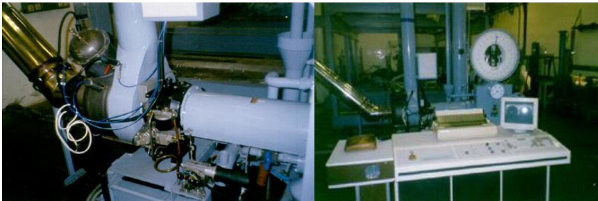
3. ábra Deutz T216 gázturbiná közelről (balra) és a próbapad eredeti kialakítása (jobbra) [8]
