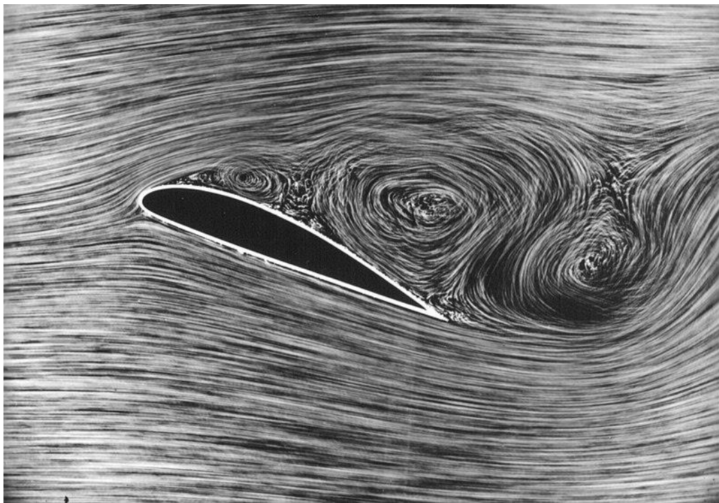
24. ábra: Átési sebesség elérése után kialakuló turbulens áramlás [34]
