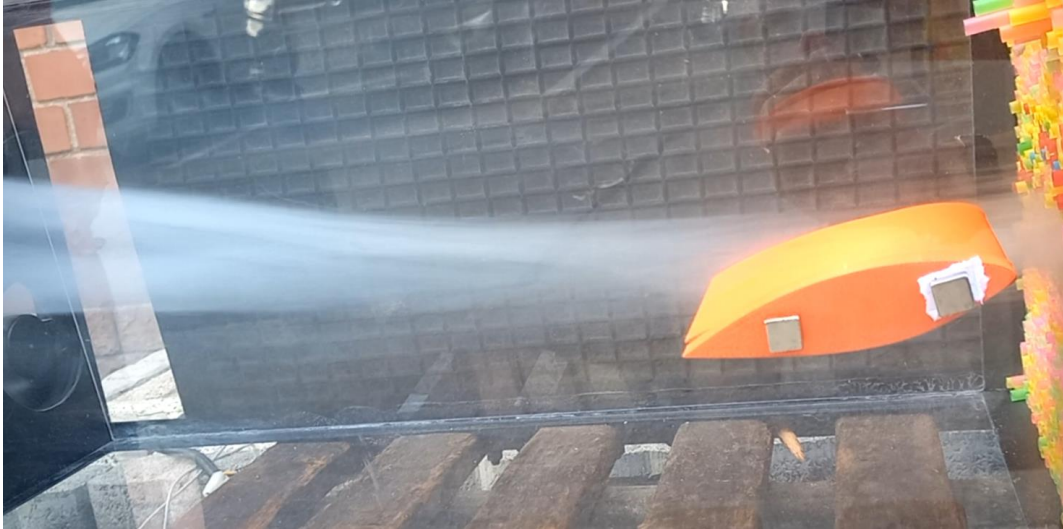
17. ábra: Füsttel kimutatott örvénylés
