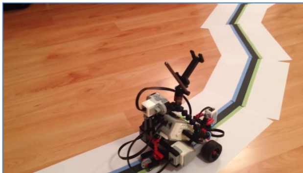
5. ábra: Lego Mindstorms EV3 vezetónélküli targonca modell optikai vezetősínnel (forrás: www.youtube.com/watch?v=I91uoc5fOcQ )
