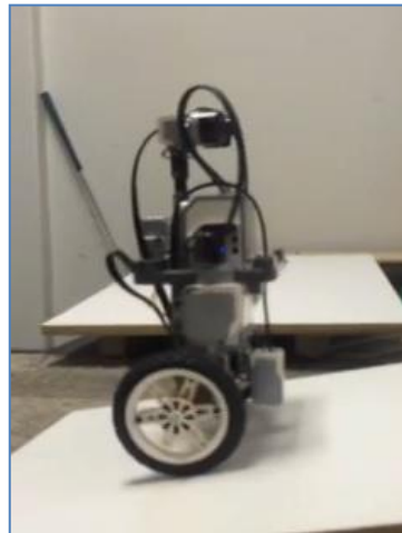
4. ábra: Lego Mindstorms EV3 ön-egyensúlyozó robot (forrás: www.youtube.com/watch?v=xz1qZLN8ux0 )
