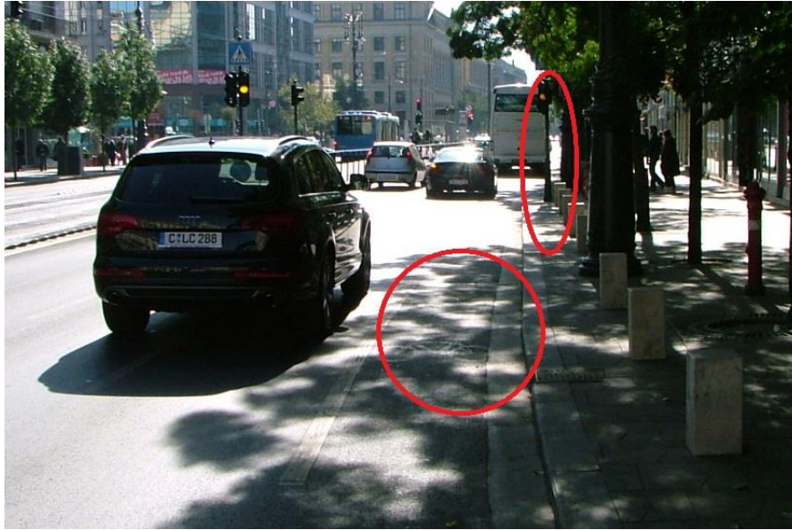
12. ábra A Deák Ferenc tér felől érkező kerékpáros sáv a csomópont előtti jelzőlámpa vonalában megszűnik (forrás: saját fotó)
