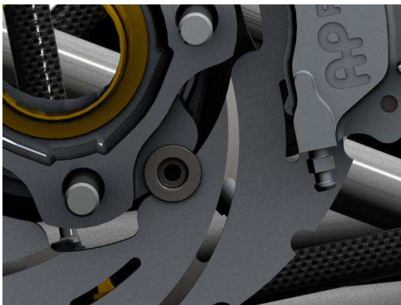
25. ábra Féktárcsa rögzítése a kerékagyhoz
