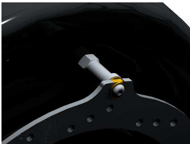
27. ábra A hátsó féktárcsa rögzítése a forgórészhez
