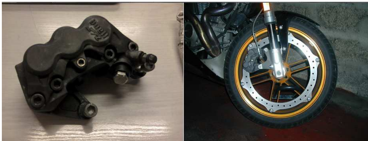
8. ábra és A megvásárolt féknyereg és egy Buell motor első kerékfékének kialakítása
