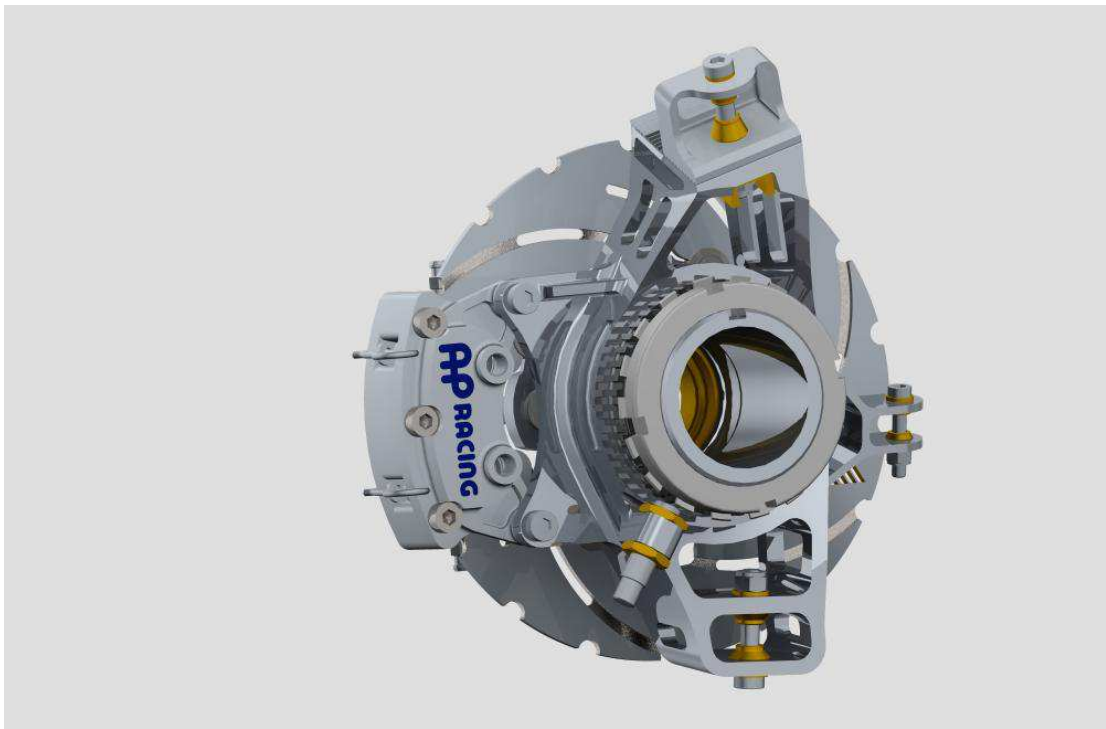
32. ábra Első tengelycsonk a hozzá csatlakozó alkatrészekkel, hátnézet
