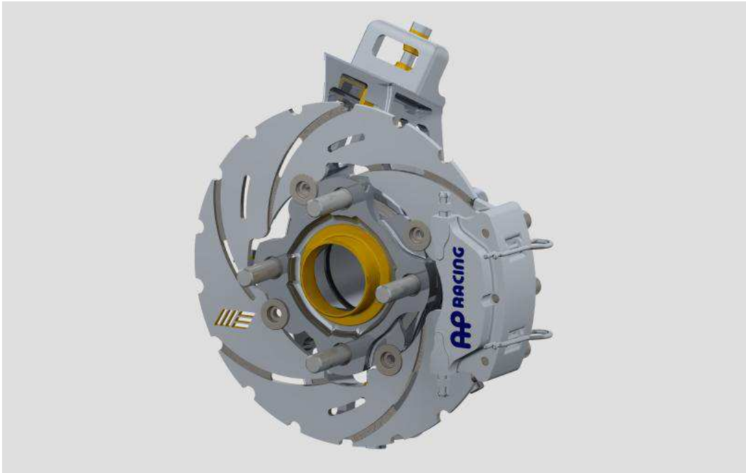
31. ábra Első tengelycsonk a hozzá csatlakozó alkatrészekkel, előlnézet
