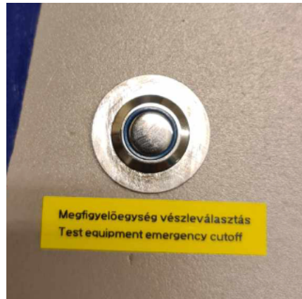
fig. 4.5.2. Már beépített vészleállító gomb, a kétnyelvű matricájával.
