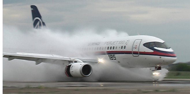
10.ábra: Sukhoi SuperJet 100 –as típusú repülőgép leszállás utáni fékezése nedves futópálya felületen[13]
