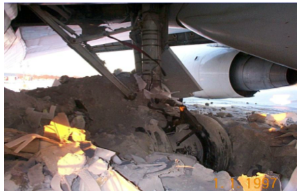
15.ábra: EMAS biztonsági rendszer által megfékezett légijármű futóműve a biztonsági felületbe süllyedve.
