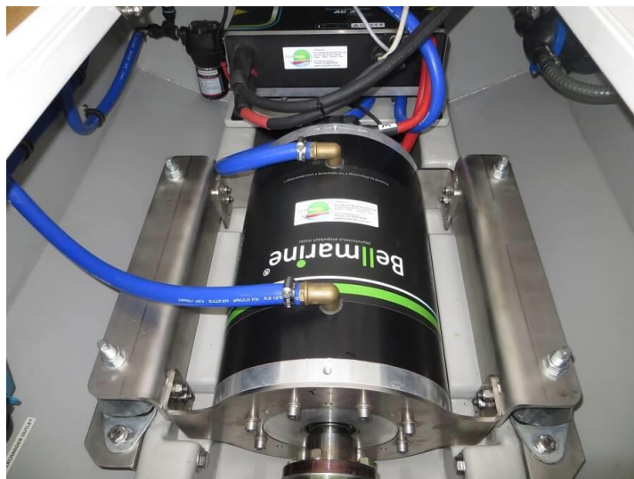
27. ábra: Példa hajóba épített elektromos motorra (17)
