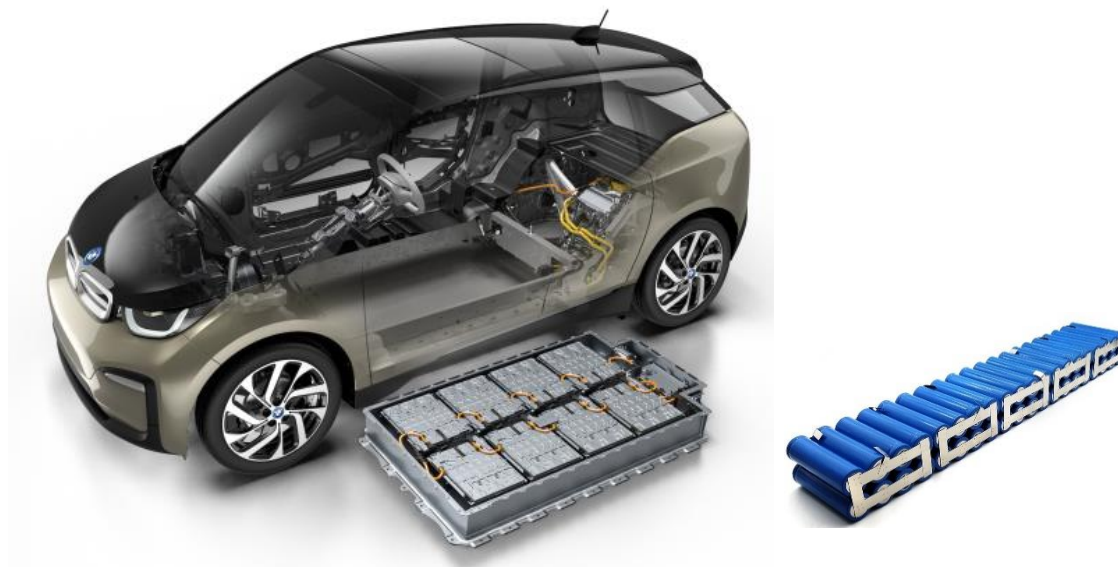
6. ábra: A BOSCH csoport akkumulátora közúti példán és az e-bike akkumulátorai (nagyításban) (16)
