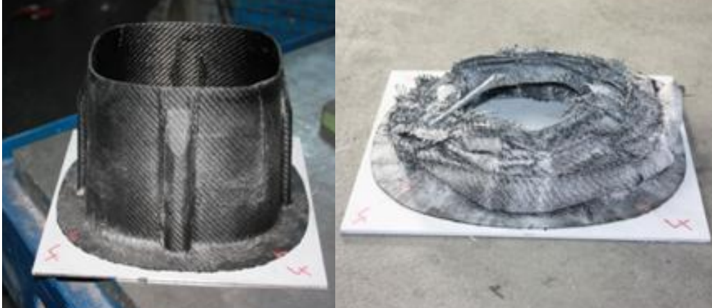
2.16.ábra Versenyautó crashbox, eredeti és deformálódott állapotban[9]
