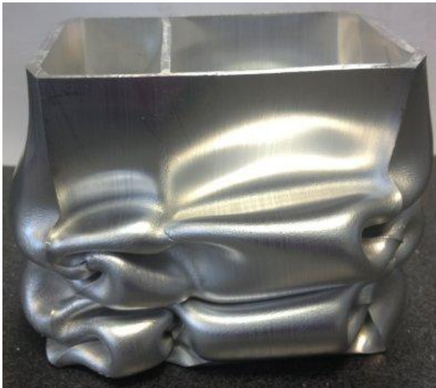
4.8.ábra. A harmadik laborvizsgálat töréstesztjének eredménye
