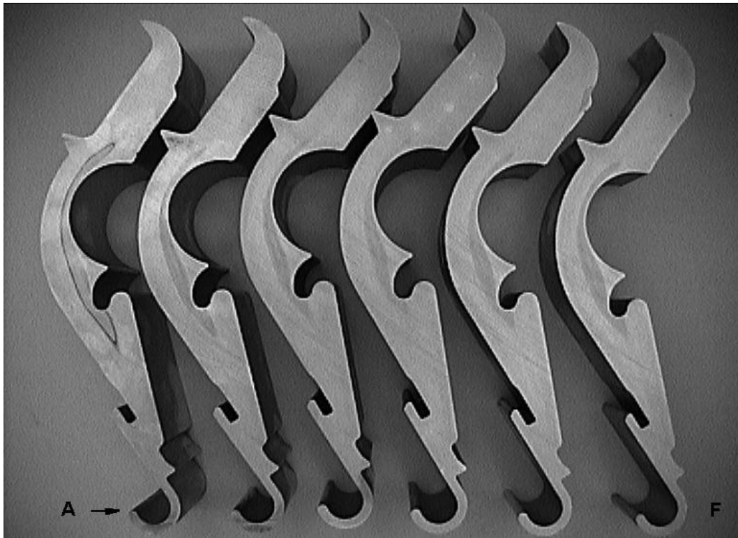
3.13. ábra. Besajtolási sorozat makrovizsgálata
