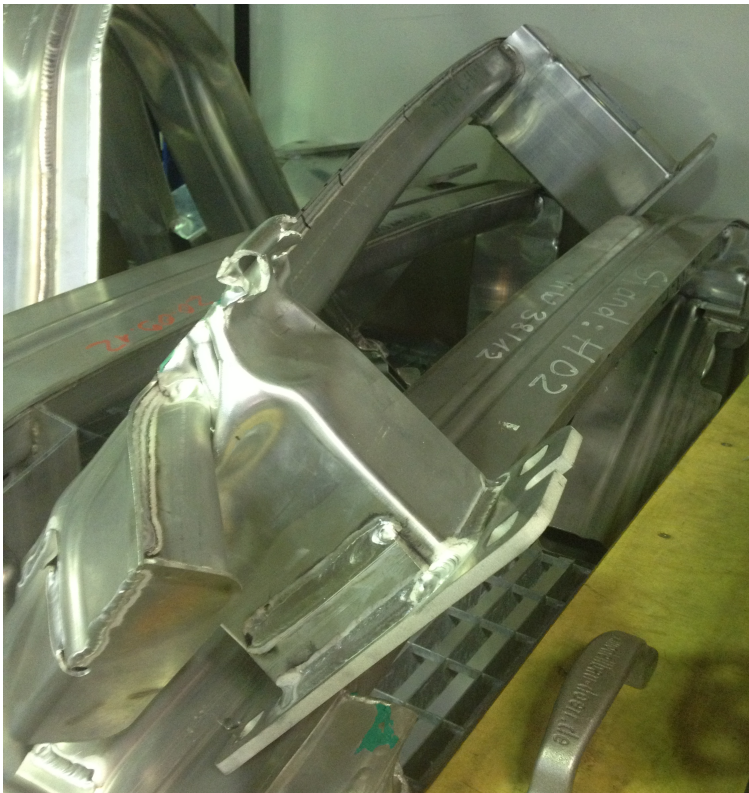
4.1. ábra. Összeszerelt és tesztelt crashbox
