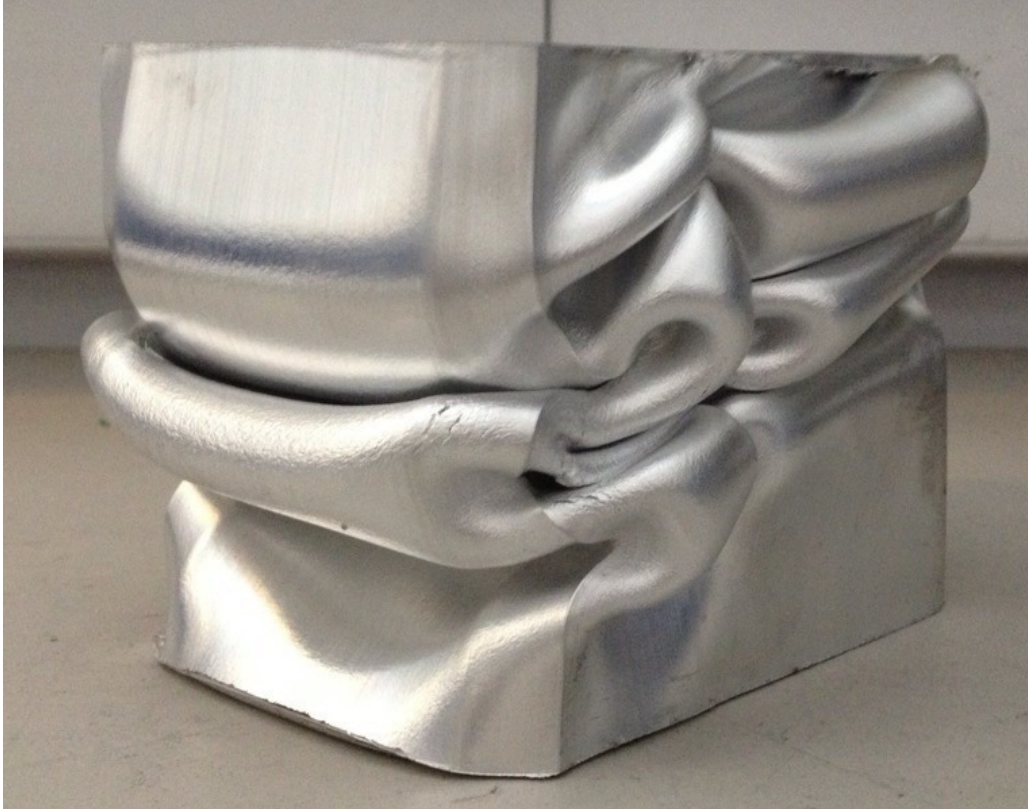
4.5. ábra. A második laborvizsgálat töréstesztjének eredménye
