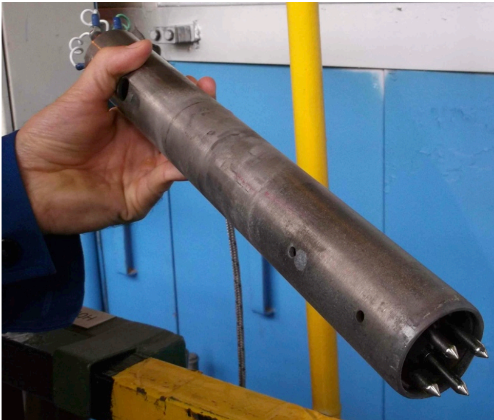
3.4. ábra Az Elhaus kemencében felhevített tuskó hőmérsékletének mérése
