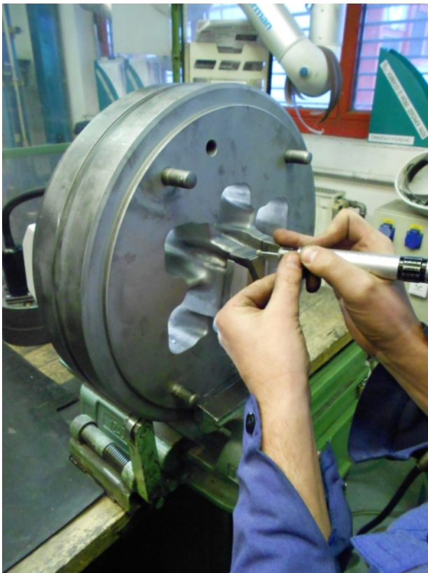
3.2. ábra. Kézi szerszámkorrekció
