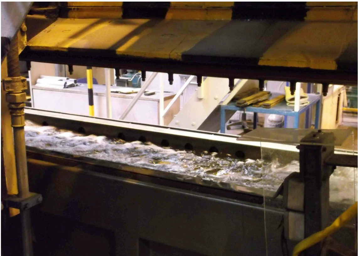
3.10. ábra Álló hullámú vízű hűtő berendezés
