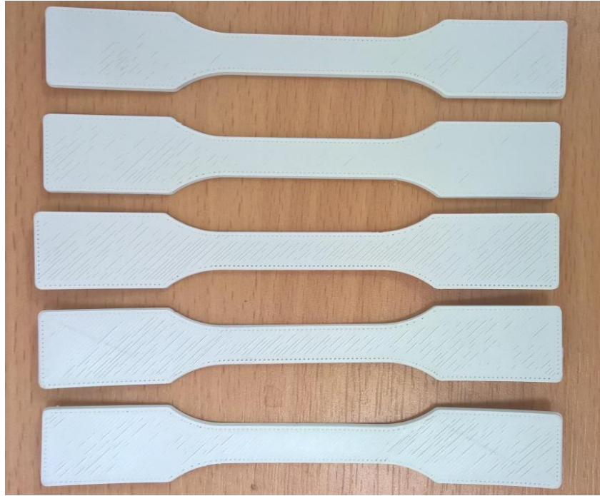
31. ábra: A húzóvizsgálathoz készült szabványos próbatestek
