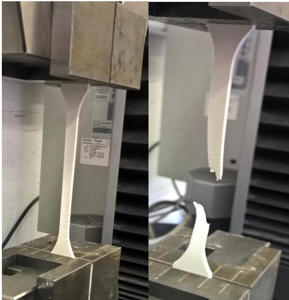
35. ábra: A kép bal oldalán látható, próbatest húzóvizsgálat közben, ahol már tapasztalható a plasztikus deformáció, a jobb oldalán az elszakadt próbatest látható.
