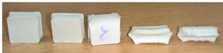
44. ábra: A próbatestek nyomóvizsgálat után
