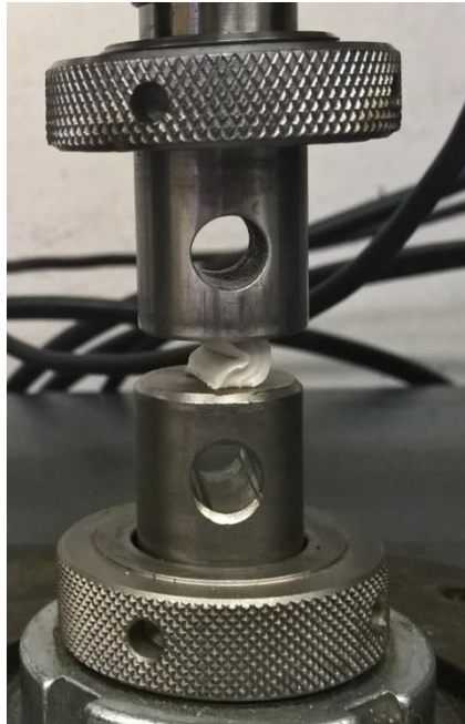
16. ábra: Soft PLA anyag nyomóvizsgálat során kialakult alakváltozása
