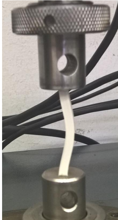
39. ábra: A nyomó erő hatására a próbatest kihajlik.
