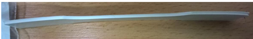
48. ábra: Az y pozícióban nyomtatott húzó próbatest felszedése utáni deformáció
