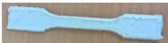
30. ábra: 1mm/másodperc sebességgel előállított, kicsinyített próbatetest
