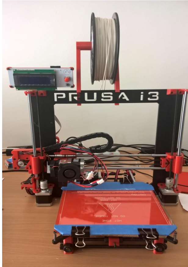
19. ábra: Prototípusok gyártására alkalmazott 3D nyomtató (Hephestos Prusa i3)
