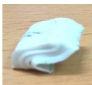
46. ábra: Delaminálódott próbatest
