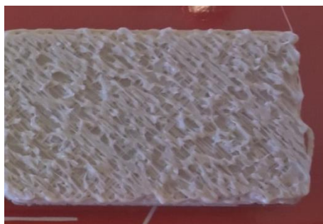
23. ábra: A nem megfelelő, lyukacsos szerkezetű réteg nyomtatás során
