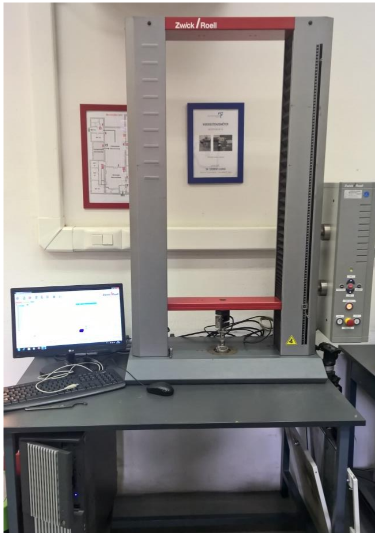
34. ábra: Mérés során alkalmazott akkreditált szakítógép
