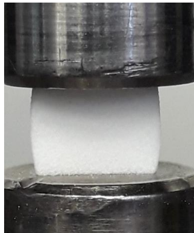
15. ábra: Hordósodás konkrét példa alapján
