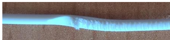
26. ábra: Kép a huzalról, ahol a fogaskerék belerágott az anyagba
