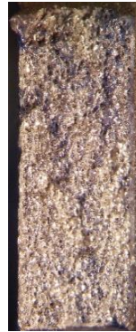
Ábra 2-17: TP9 minta szakadási felülete Specimen 1.14
