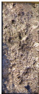
Ábra 2-15: TP6 minta szakadási felülete Specimen 1.5
