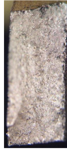
Ábra 2-25: TPXY minta szakadási felülete Specimen 1.27
