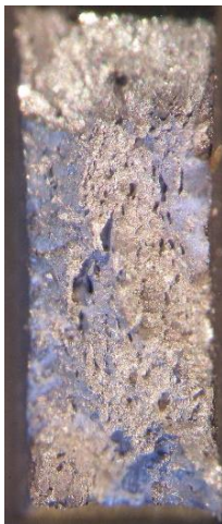
Ábra 2-24: DP minta szakadási felülete Specimen 1.2
