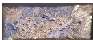
Ábra 2-11: DP minta szakadási felülete Specimen 1.2
