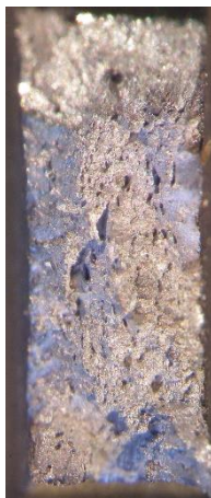
Ábra 2-21: DP minta szakadási felülete Specimen 1.2
