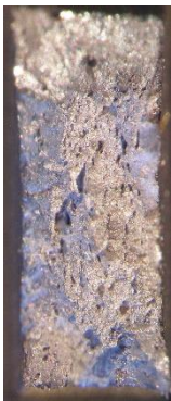
Ábra 2-16: DP minta szakadási felülete Specimen 1.2
