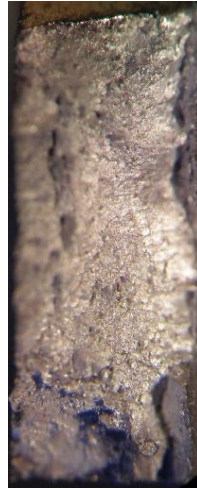
Ábra 2-26: TPX minta szakadási felülete Specimen 1.23
