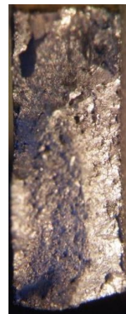
Ábra 2-20: TP11 minta szakadási felülete Specimen 1.19
