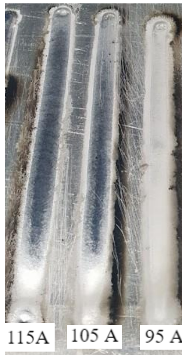
10. Ábra-Szürke elektróda próbavarratai
