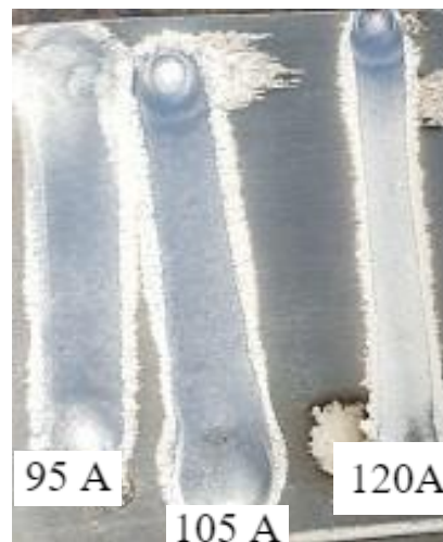
9. Ábra-Zöld elektróda próbavarratai
