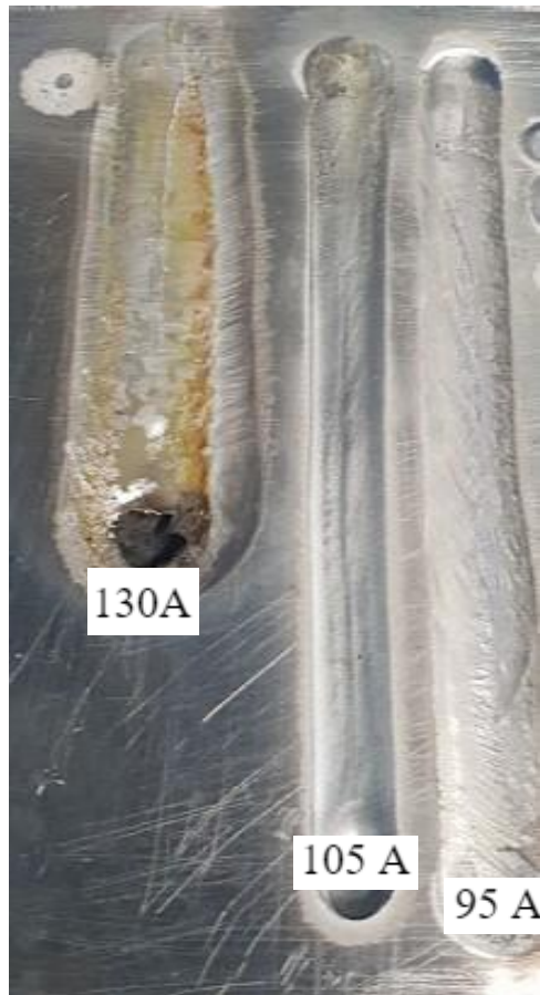
11. Ábra-Arany elektróda próbavarratai
