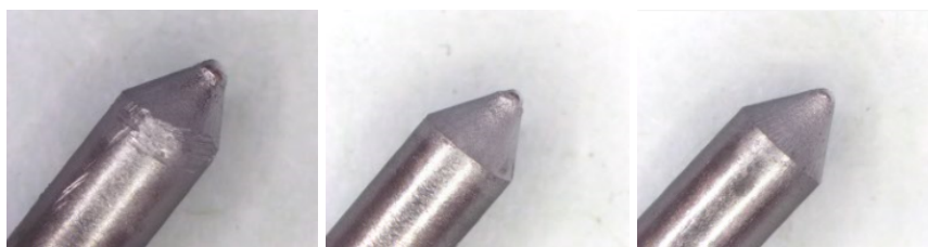
20. Ábra-A 60°-os kúpszögű elektródák 20 ívgyújtás után sorban: szürke, arany, türkiz
