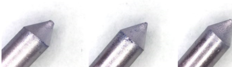
24. Ábra-60°-os kúpszögű elektródák folyamatos hegesztés után sorban: szürke, arany, türkiz
