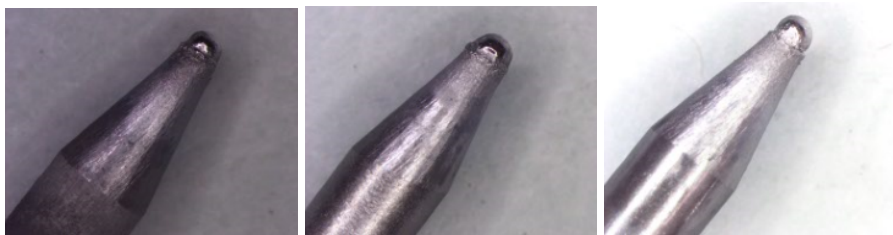
19. Ábra-A 20°-os kúpszögű elektródák 20 ívgyújtás után sorban: szürke, arany, türkiz
