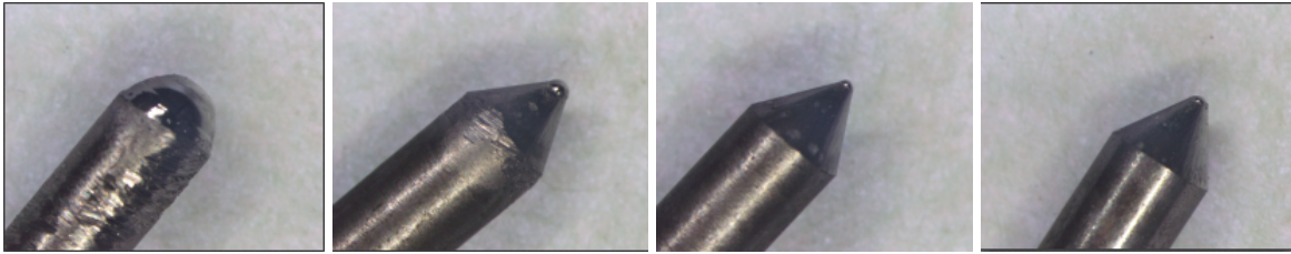
16. Ábra-A 60°-os kúpszögű elektródák 1 ívgyújtás után sorban: zöld, szürke, arany, türkiz
