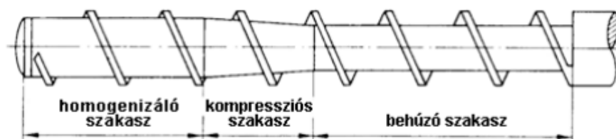
17. ábra Az extrudercsiga felépítése és szakaszai
