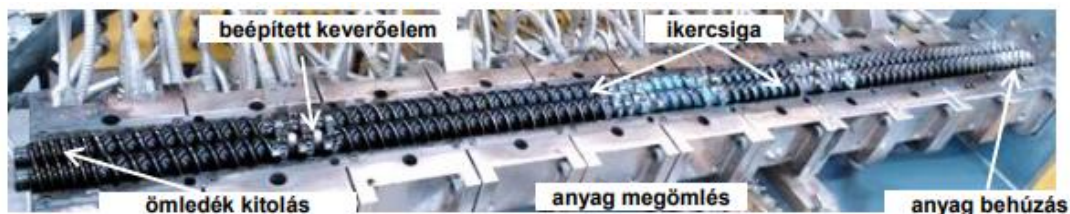
18. ábra Ikercsiga felépítése és szakaszai
