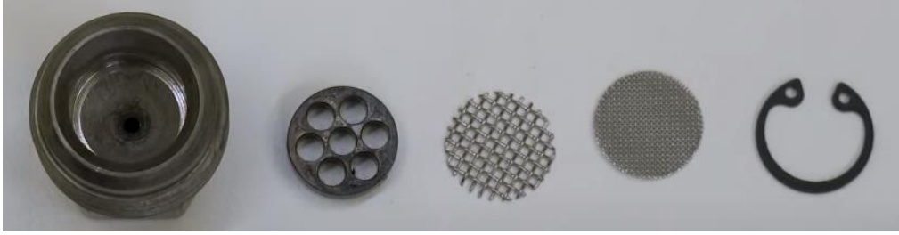
40. ábra Fúvóka belső felépítése és alkatrészei
