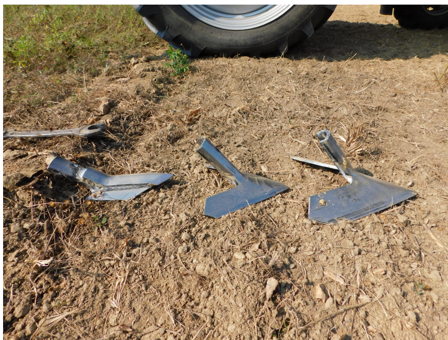
4.1. ábra. Méréshez használt három különböző geometriájú (balról jobbra: keskeny, közepes, széles) kultivátor kapa
