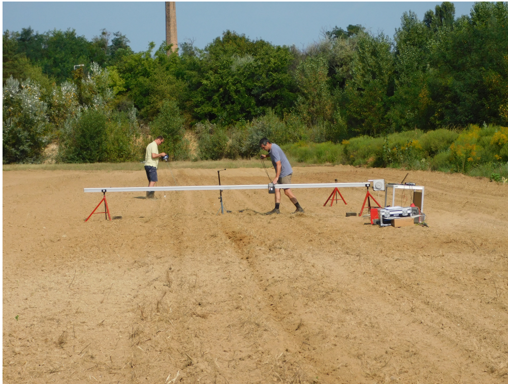
4.2. ábra. A lézeres profilográf, amit a felszínprofil mérésére használtak
