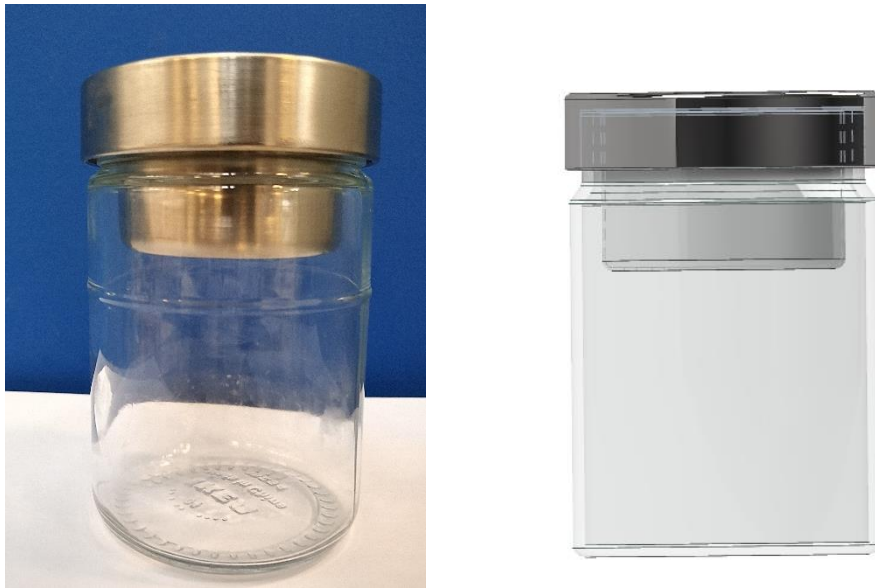
9. ábra Oldattartó edényként használt DAGKLAR üvegedény fotója és 3D modellje
