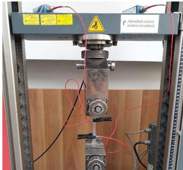
15. ábra: Gyanta próbatest szakítóvizsgálatának mérési elrendezése
