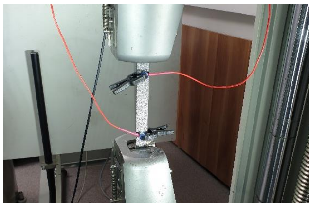
17. ábra: Mikrofonok elrendezése a befogott kompozit próbatesten
