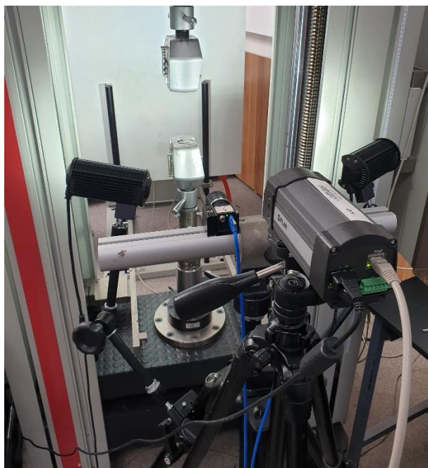
16. ábra: Kompozit próbatest szakítóvizsgálatának mérési elrendezése
