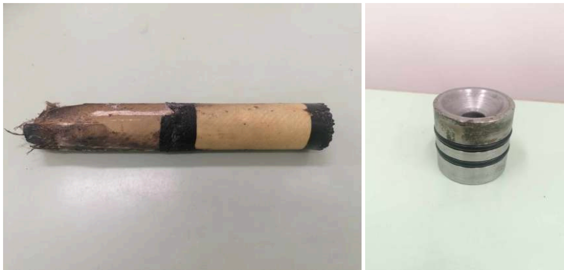
22. ábra. A motor belső borítása (balra) és a fűvóka a teszt után.
