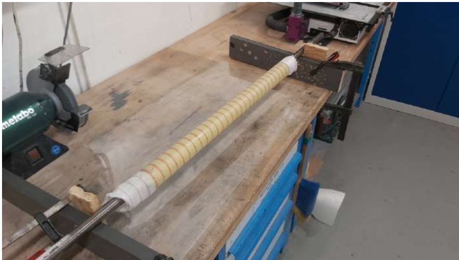
9. ábra. A hajtómű belső borítása gyártás közben.
