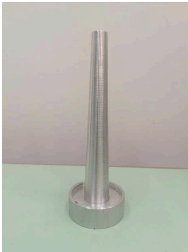
11. ábra. A hajtóanyag-pogácsák gyártását elősegítő kúpos szerszám.
