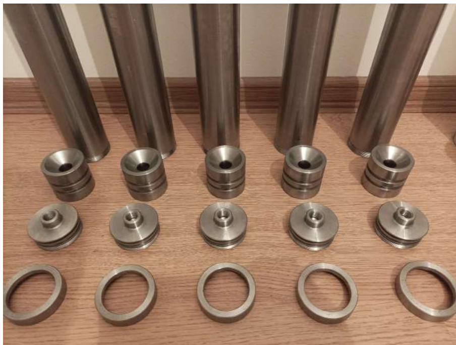
6. ábra. A rakétamotor alkatrészei. Fentről lefelé: az égéskamra, a fúvóka, a nyomás-méréshez szükséges adapter és a fúvóka rögzítőgyűrűje
