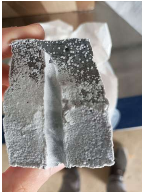
16. ábra. A cukros technológiával készült próbatest. A képen láthatóak apró kis buborékok az anyagban. A felszínen megjelenő fehér foltok a hajtómű anyagának kikristályosodása, ez a mintán több hónapos állás után jelent meg.
