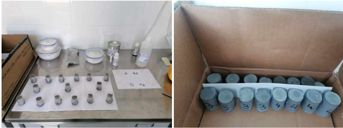
14. ábra. A gyanta alapú hajtóanyag-próbatetek. Balra az öntés utáni állapotban, jobbra pedig a már megszilárdult próbatetek láthatóak.
