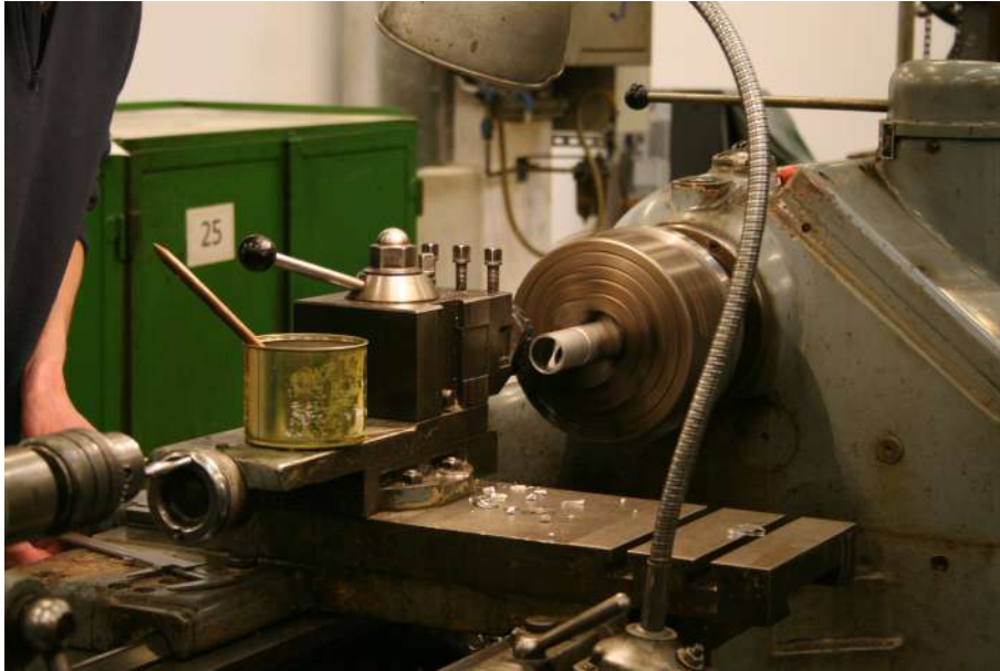
7. ábra. Az égéskamra burkolata esztergálás közben.
