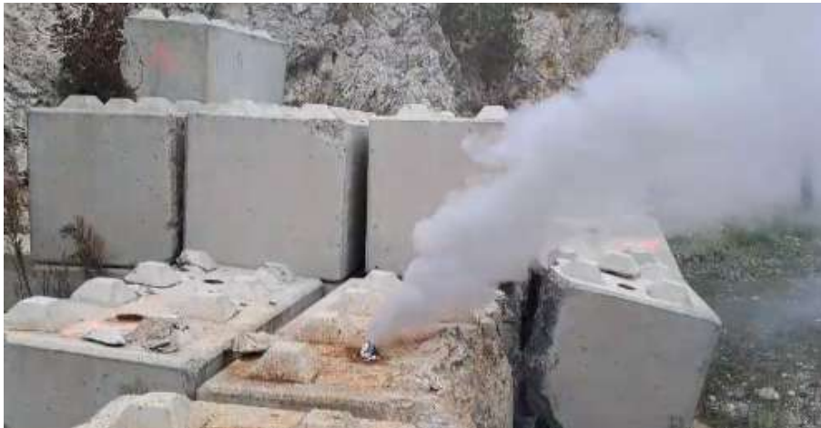
17. ábra. A begyulladt, cukros technológiával készült mintadarab.
