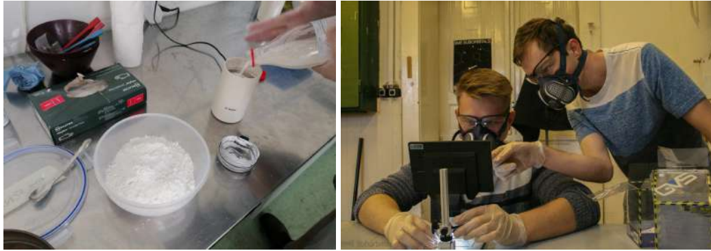
12. ábra. Az alapanyagok őrlési munkafolyamata (balra) és a leszitált por szemcseméretének ellenőrzése mikroszkóp segítségével.
