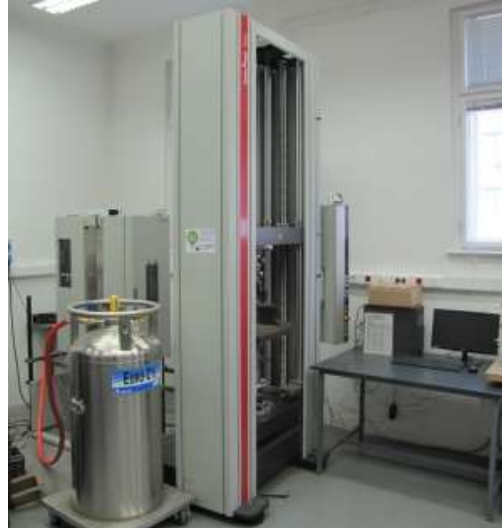
Fig. 8. Zwick Z250 type tensile tester [15].
