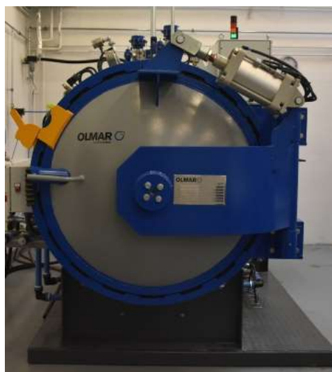
Fig. 7. Olmar ATC 1100/2000 type autoclave [15].
