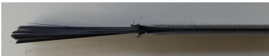
22. Ábra Ferde végű fülekkel ellátott próbatest a húzóvizsgálat után. A fülek részleges elválása gyakran előfordult
