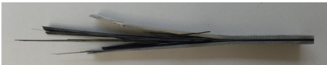
24. Ábra X-pillangó próbatest a húzóvizsgálat után. Ennél a típusnál, hasonlóan a ferde végű fülekkel ellátotthoz, jellemző volt a fülek részleges elválása
