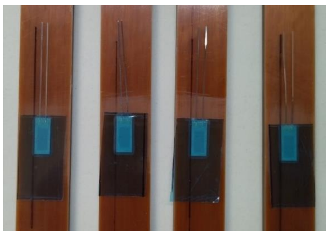
19 Ábra (D típusú) próbatetek nyúlásmérő bélyegek felragasztása előtt. A nyúlásmérőbélyegek helyre igazítását átlátszó ragasztószalag segítségével végeztem
