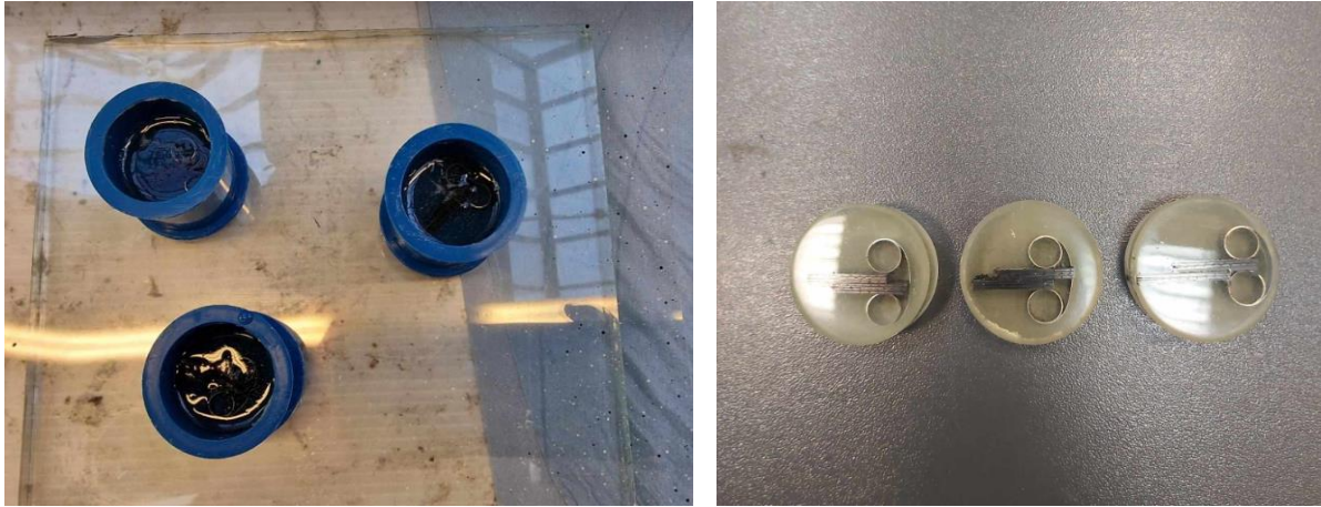
57. ábra: A beágyazott minták gyanta öntés után (bal) és csiszolás, polírozás után (jobb)
