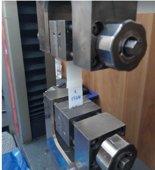
37. ábra: Fröccsöntött próbatest nyíróvizsgálata
