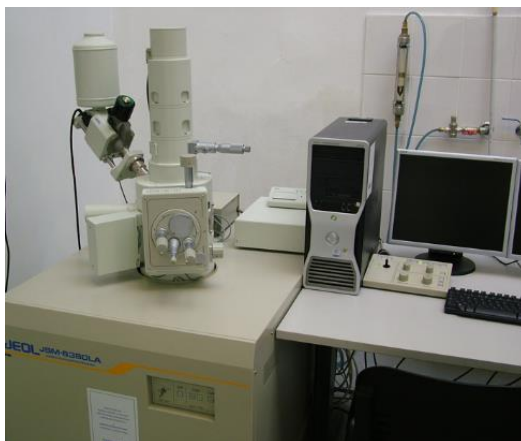
29. ábra: Jeol márkájú pásztázó elektronmikroszkóp [48]
