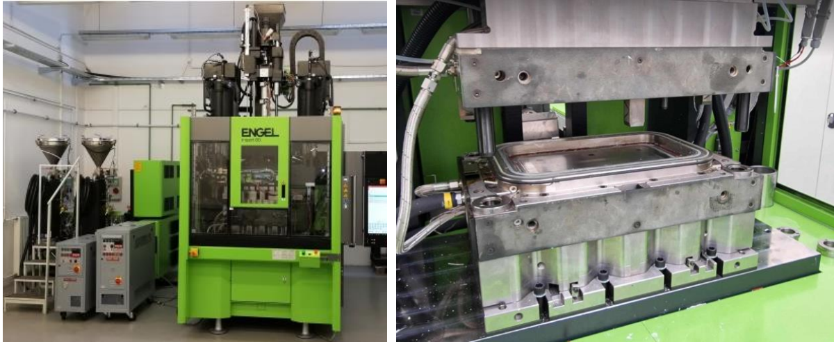
25. ábra: T-RTM technológiához használt fröccsöntőgép [44] és szerszám
