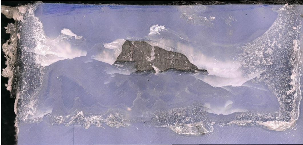
59. ábra: Mátrix anyag habosodása 2 rétegű kompozitnál
