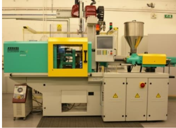
27. ábra: Arburg Allrounder Advance 270S fröccsöntőgép [46]
