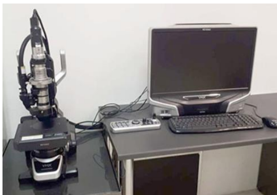
30. ábra: Keyence gyártmányú optikai mikroszkóp [49]
