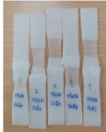
39. ábra: A próbatesten nyakképződés figyelhető meg
