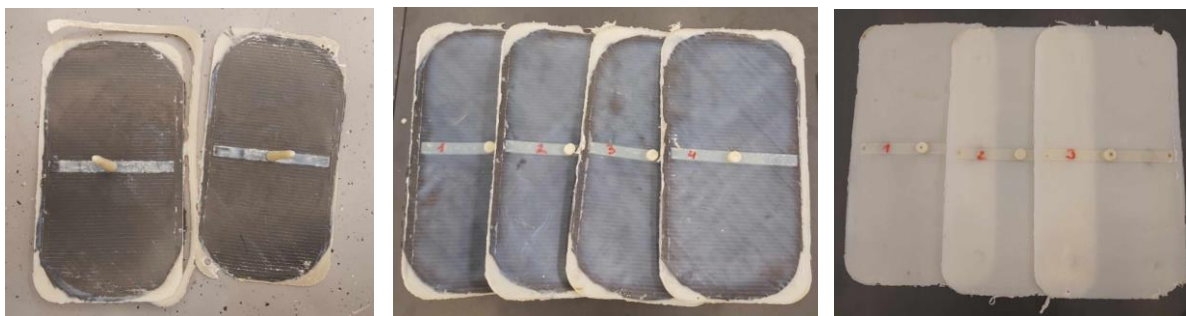
33. ábra: A készített lapok: 4 rétegű (bal), 2 rétegű (közép), erősítőanyag nélküli PA6 (jobb)
