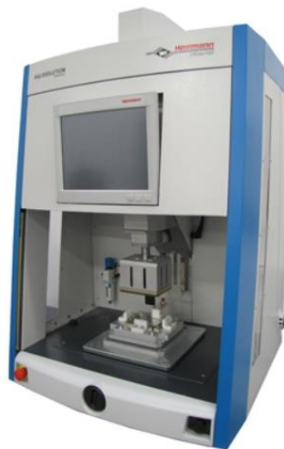
26. ábra: Herrmann Ultraschalltechnik márkájú ultrahangos hegesztő berendezés [45]
