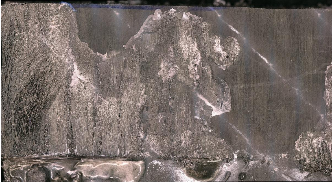
61. ábra: 4 rétegű kompozit töretfelülete
