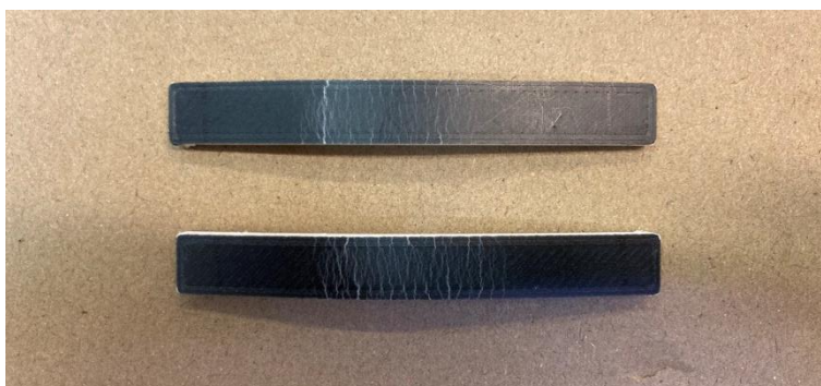
27. ábra A 2cf16h2cf minta húzott oldala
