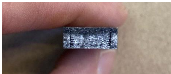
26. ábra A CF10 minták keresztmetszete
