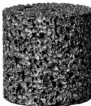
3.2.ábra Példa a zárt cellás fémhabra[32]
