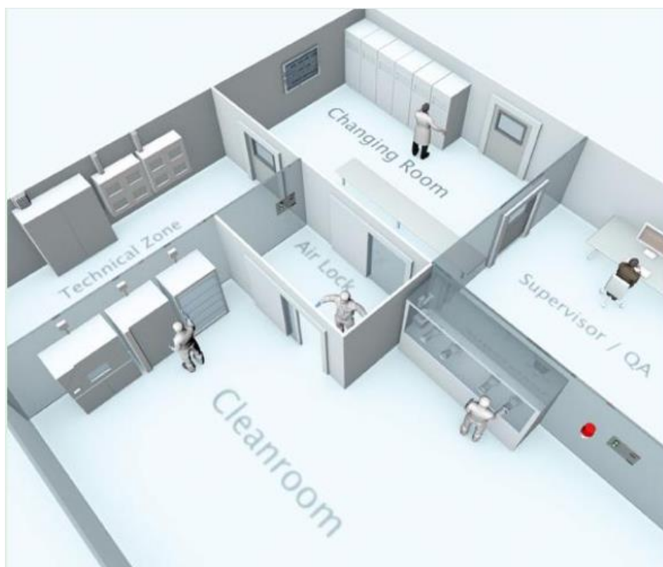
25. ábra. Egy lehetséges gyógyszeripari tisztatéri elrendezés
