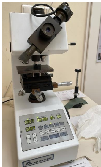
15. ábra A mérés során használt Buehler márkájú mikrokeménységmérő
