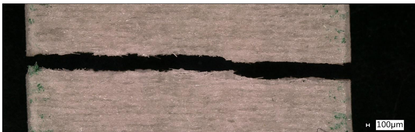
25. ábra - GF 25%-os minta töretfelülete 60x-os nagyításban
