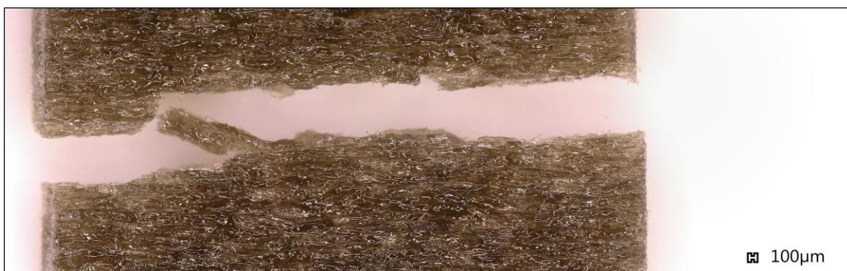
31. ábra - BF 25% -os minta töretfelülete 60x-os nagyítás esetén
