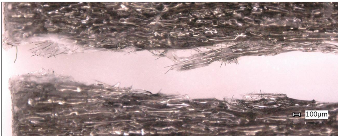
29. ábra - CF 25%-os minta töretfelülete 100x-os nagyítás esetén
