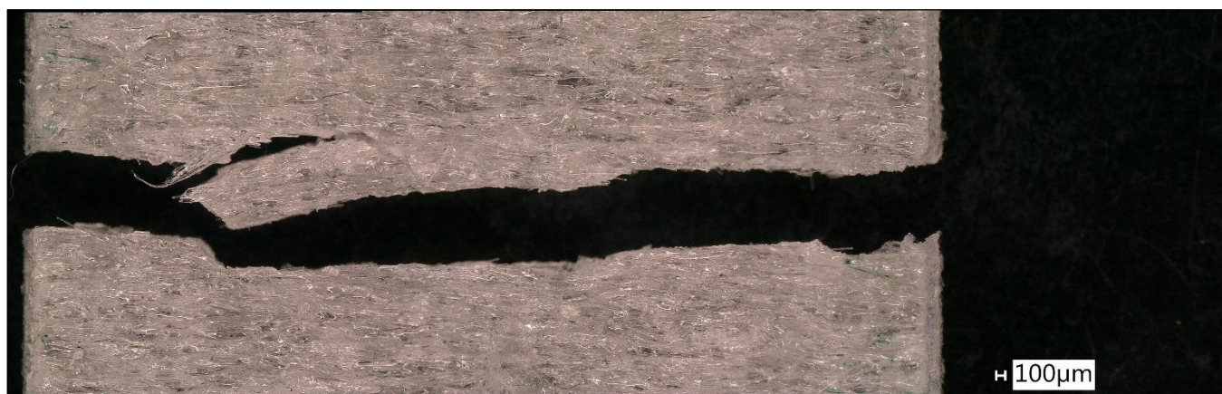
24. ábra -GF 5% -os minta töretfelülete 60x-os nagyításban
