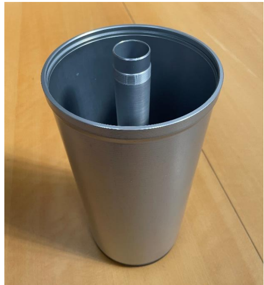
7. ábra: A tartály fő alkatrészei, valamint összeszerelt állapota (1: tartályfenék, 2: tartály, 3: központi henger, 4: rögzítő anya, 5: domború rácslemez, 6: cseppfogó, 7: rugó, 8: rugóleszorító anya, 9: menetes szár)
