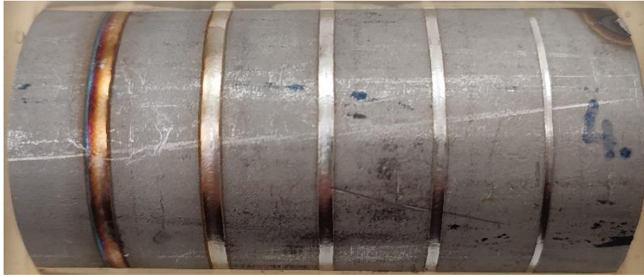
23-24. ábra: 40 cm/min haladási sebesség mellett készített varratok fényképe, balról jobbra 60%-tól 20%-ig 10%-onként csökkentve a leadott lézerteljesítményt
