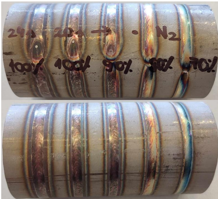
21-22. ábra: 40 cm/min haladási sebesség (első varrat kivétel – 33 cm/min) mellett készített varratok fényképe, balról jobbra 100%-tól 70%-ig 10%-onként csökkentve a leadott lézerteljesítményt
