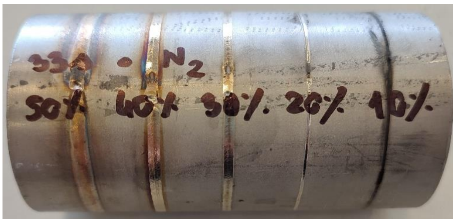
17-18. ábra: 24 cm/min haladási sebesség mellett készített varratok fényképe, balról jobbra 100%-tól 60%-ig 10%-onként csökkentve a leadott lézerteljesítményt
