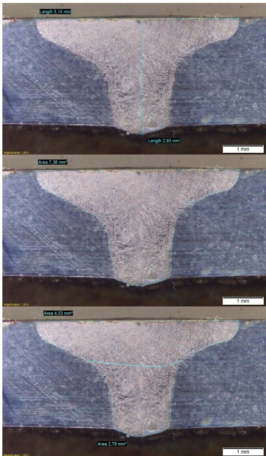
25-27. ábra: 24 cm/min haladási sebesség és 100%-os lézerteljesítmény mellett készített varrat keresztmetszeti képeinek méretezése
