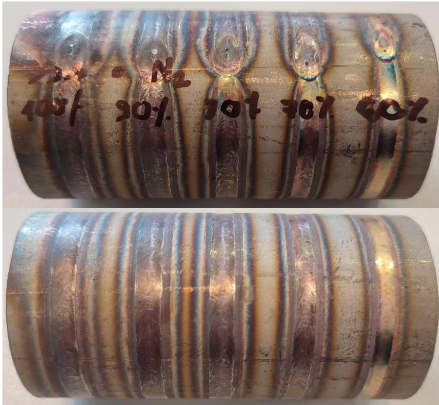
17-18. ábra: 24 cm/min haladási sebesség mellett készített varratok fényképe, balról jobbra 100%-tól 60%-ig 10%-onként csökkentve a leadott lézerteljesítményt
