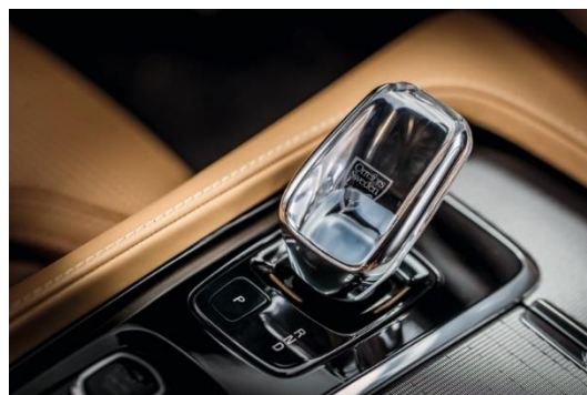
6. Ábra/B: Automata sebességváltókar Volvo (irányválasztó)
