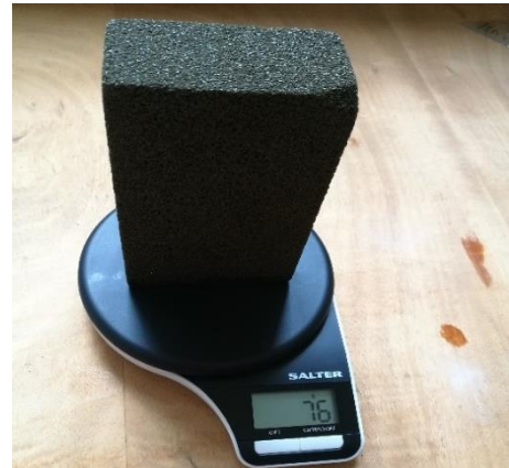
46. ábra Próbatetest 10 perc után kivétele és mérése
