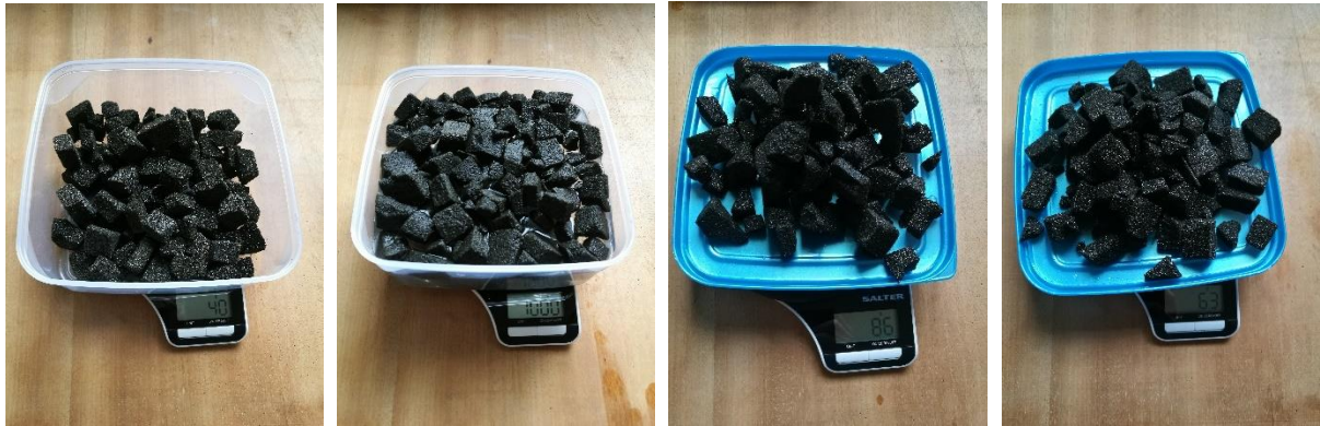
50. ábra Granulátum vízfelvétel vizsgálata
