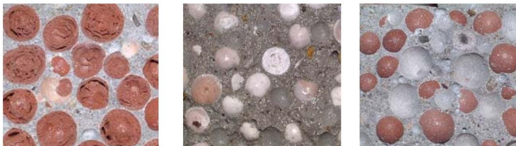
9. ábra Törésképek: 1. elhasadt szemcsék, 2. vegyes, 3. kifordult szemcsék [1]
