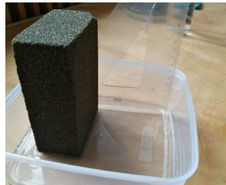
43. ábra Próbatetest behelyezése 5 mm mélyen vízbe
