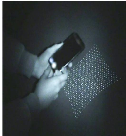
*iPhone 13 Pro LiDAR pont projektorának kivetített ponthálójáról készített infravörös kép
