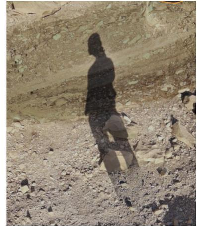
*scannelés közben rögzített árnyék megjelenése a textúrázott modellen (képernyőkép)*
