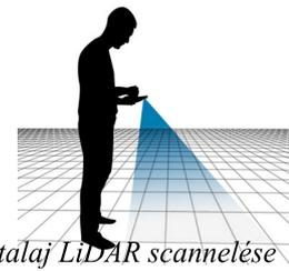
*sík talaj LiDAR scannelése*
