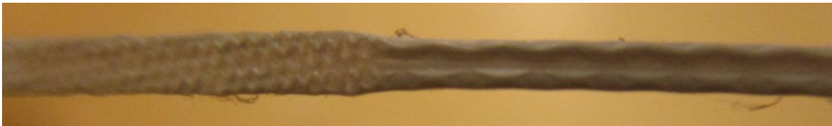
13. ábra: Fotó - Szálszerkezet roncsolódása a befogásnál
