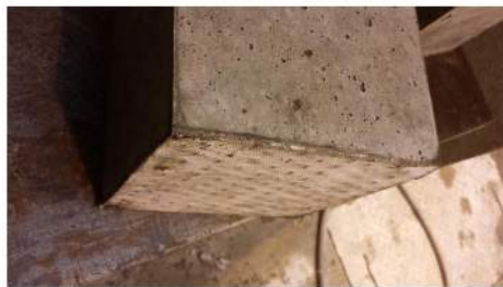
A próbatetek elhelyezése a vízzáróságmérő berendezésben
