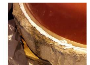
A házi kísérletünket nem sikerült befejezni, mert a szilikon nem biztosított megfelelő tömítést, a víz kifolyt
