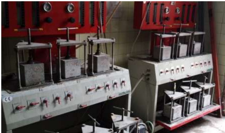
A laterális vízvándorlási ellenállás mérése laboratóriumi körülmények között
