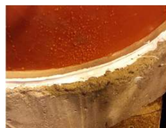
A házi kísérletünket nem sikerült befejezni, mert a szilikon nem biztosított megfelelő tömítést, a víz kifolyt
