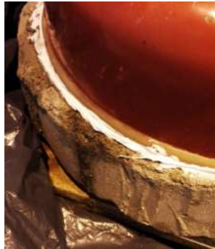
Kísérlet sikertelensége: szilikon alatt kifolyik a víz
