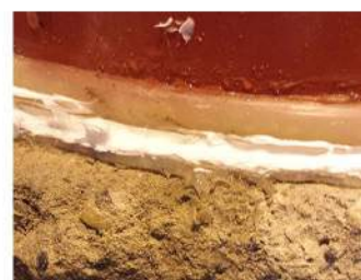
A házi kísérletünket nem sikerült befejezni, mert a szilikon nem biztosított megfelelő tömítést, a víz kifolyt
