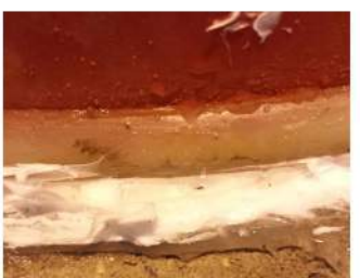
A házi kísérletünket nem sikerült befejezni, mert a szilikon nem biztosított megfelelő tömítést, a víz kifolyt
