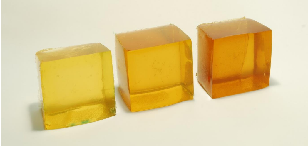
4. ábra Különböző mennyiségű GDA oldattal térhálósított zselatin kockák
