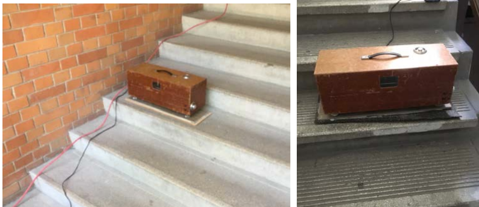
8. ábra: Az St. épület és a panelház lépcsőkarján működtetett kopogógép
