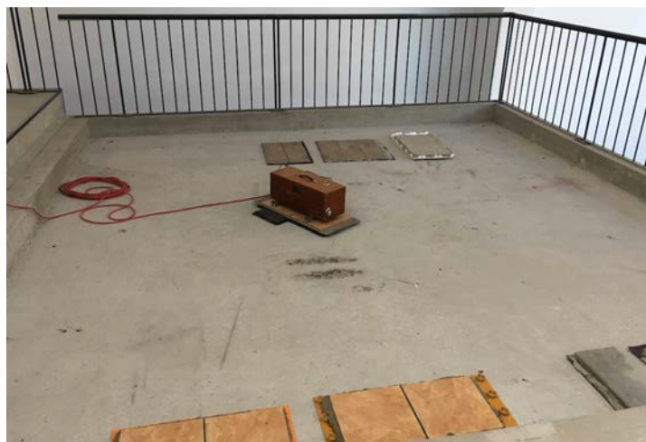
6. ábra: A laborfödémre helyezett minták mérése a szabványos kopogógéppel
