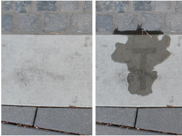
46. kép: A különböző hidrofobizáltságú betonok Fotó: saját kép
