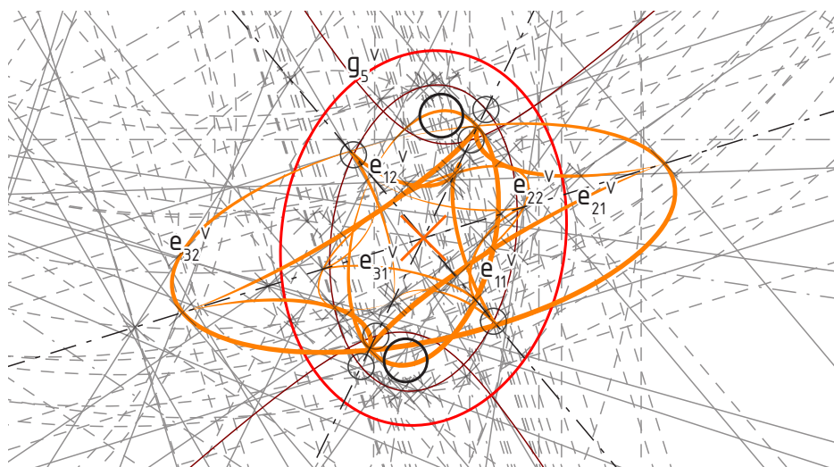
8. ábra: Háromtengelyű ellipszoid fokális felületeinek speciális görbéinek általános vetülete 12.1 ábra V. képe kinagyítva g : Az ellipszoid kontúrgörbéi e : A fokális felületek speciális síkgörbéi
